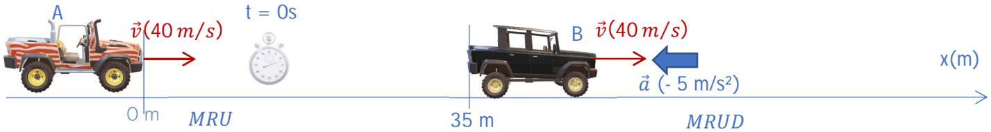
On peut donc, et pour deux secondes, seulement, écrire l'équation du MRU du véhicule A et celle du MRUD du véhicule B. Dans ce cas, l'équation  $x_A(t)$  caractérise la position du pare-chocs avant de la voiture A, tandis que l'équation  $x_B(t)$  caractérise la position du pare-chocs arrière de la voiture B.
