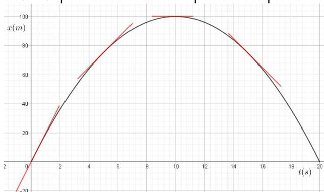
On observe bien que, sur ce graphe, la pente de la tangente (tracée en rouge), càd la vitesse, est positive et qu'elle diminue progressivement, entre  $t=0$  et  $t=10s$ , pour atteindre 0 au sommet de la parabole, càd en  $t=10s$ . Elle devient ensuite de plus en plus négative (càd de plus en plus grande dans le sens opposé au référentiel).
