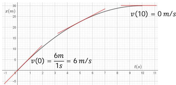
2. Soit le graphique de la vitesse en fonction du temps d'un objet en MRUV. A l'instant initial cet objet se trouve à la position  $x = 0m$ .
