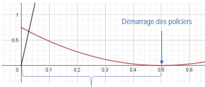
La parabole existe, mathématiquement pour tous les temps, mais, physiquement, cette partie de courbe n'existe pas. En effet, durant les  $0,5$  premières secondes, la voiture est à l'arrêt et donc, il faudrait tracer un segment horizontal en  $x=0$  entre  $t=0$  et  $t=0,5\text{s}$ . La première racine est donc à rejeter puisqu'à cet instant, le mouvement des policiers n'a pas encore démarré.
