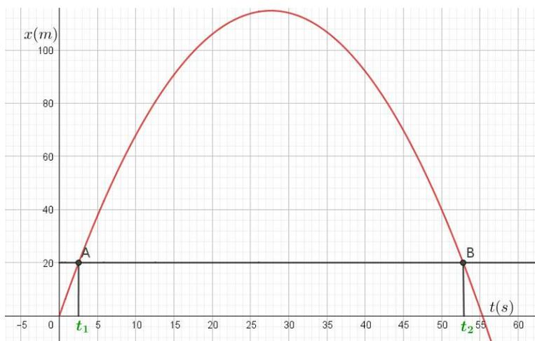
Les deux racines correspondent bien aux instants auxquels  $x$  vaut 20m, ce qui arrive une 1<sup>ère</sup> fois au point A. A cet instant, la tangente au graphe  $x(t)$  est encore positive et la vitesse aussi ! Le cycliste se déplace encore vers la droite. Au point B, la tangente au graphe  $x(t)$  est négative, ce qui correspond à une vitesse négative, c'ad à un cycliste qui se déplace vers la gauche !!!
