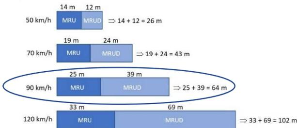
Les tests effectués sur un véhicule de masse 1000 kg (voir document ci-contre) donnent une idée de ce que peut représenter la distance d'arrêt en fonction de la vitesse du véhicule, en cas de freinage urgent. Ces tests ont été réalisés avec une voiture en parfait état et sur route sèche.
