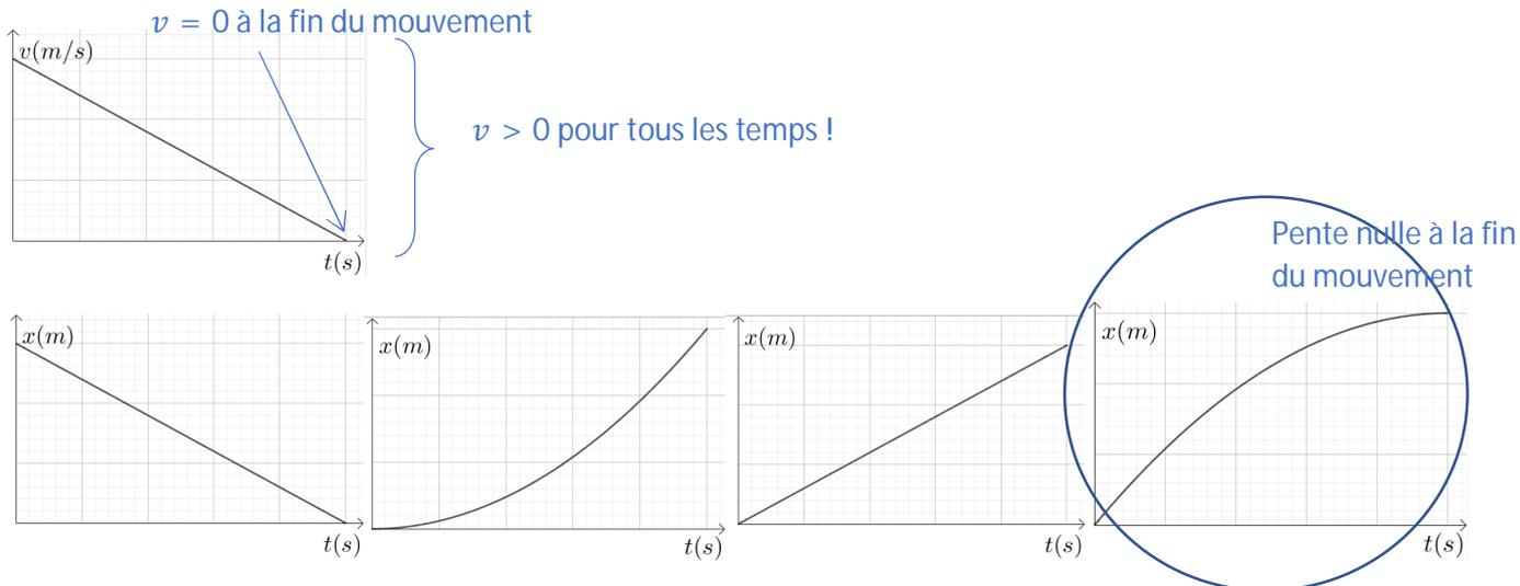
Le graphique  $v(t)$  nous apprend que la vitesse est positive et décroissante (MRUD  $v > 0$  et  $a < 0$  constante), le graphe  $x(t)$  est donc une parabole dont la concavité est tournée vers le bas ( $a < 0$ ). A la fin du mouvement, la vitesse s'annule, il faut donc que la pente de la tangente à la parabole soit nulle à l'instant final. Ces conditions correspondent au 4<sup>ème</sup> graphique de  $x(t)$ .
